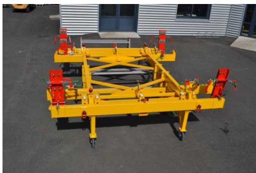
Gabarit de soudage Pignon
