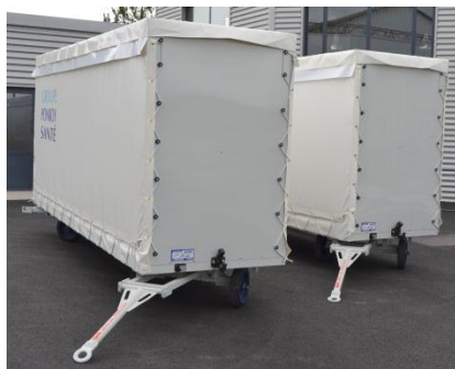
5RITR0003 - Remorque sur deux essieux directeurs pouvant être tractées l'une derrière l'autre
