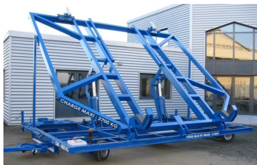
5RISPE0006 - Remorque industrielle avec plateau basculant par intégration d'hydraulique et électricité - Traine à bascule hydraulique
